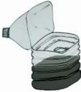
Fig. N° 14: Armado de la compostera.
