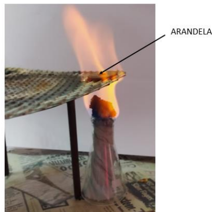
Figura N°2: Arandela expuesta al fuego.
