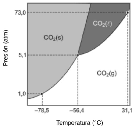
Figura 5. Diagrama de fases del Dióxido de Carbono.
