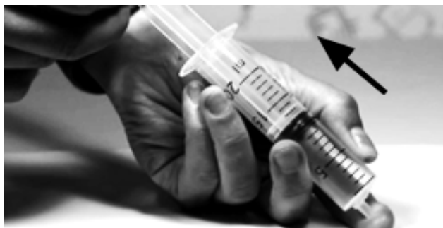
Figura 2. Mecanismo para generar vacío en la jeringa.
