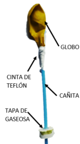
Figura 4. Dispositivo con globo.
