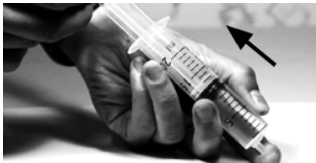
Figura 2. Mecanismo para generar vacío en la jeringa.
