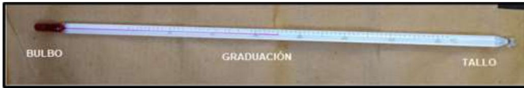
Figura 2: Partes de un termómetro.
