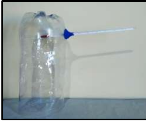
Figura 5: Termómetro sellado y sujetado con plastilina.
