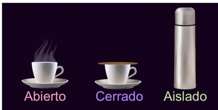
Figura 1. Clasificación de los sistemas según su interacción con el medio<sup>3</sup>.
