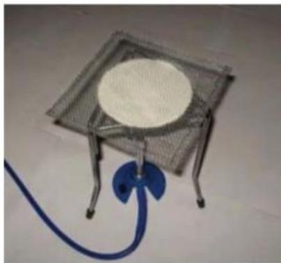
**Figura 4.** Mechero con rejilla metálica con amianto<sup>6</sup>.
