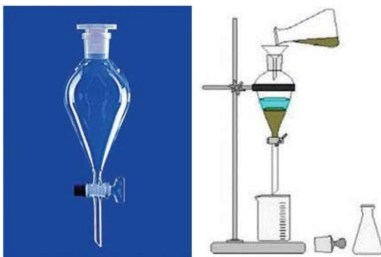
**Figura 6: Ampolla de decantación y ampolla de decantación sobre pie universal.<sup>6</sup>**
