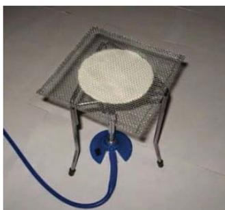
**Figura 4: Mechero con rejilla metálica con amianto.<sup>5</sup>**
