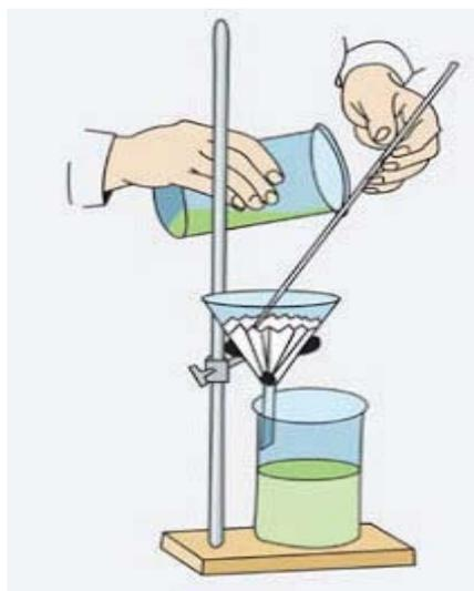
**Figura 3: Equipo de filtración<sup>4</sup>.**
