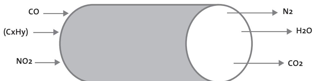
Un convertidor catalítico contiene entre 1 y 3 gramos de platino metálico mezclado con rodio. El platino cataliza las reacciones que convierten el CO y los hidrocarburos. El rodio cataliza la conversión de los óxidos de nitrógeno a sus elementos.
