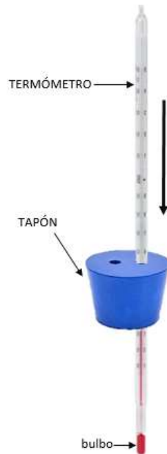
Figura N°6: Termómetro dentro del extremo más estrecho del tapón.
