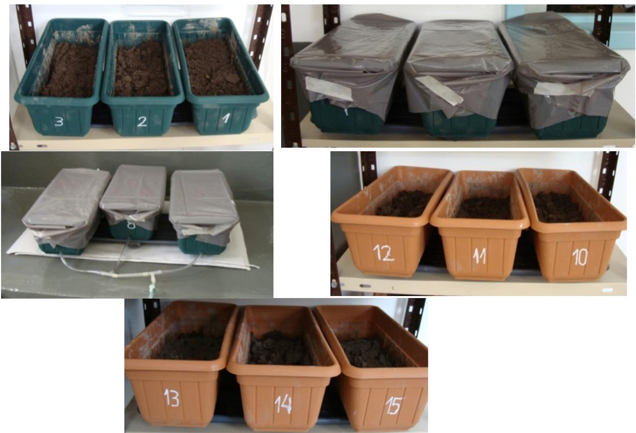
Figura 1: Sistemas analizados. De izquierda a derecha y de arriba hacia abajo: Sistemas Estándar, Sistemas Tapados, Sistemas con Aireación Forzada, Sistemas Inoculados y Sistemas Abióticos
