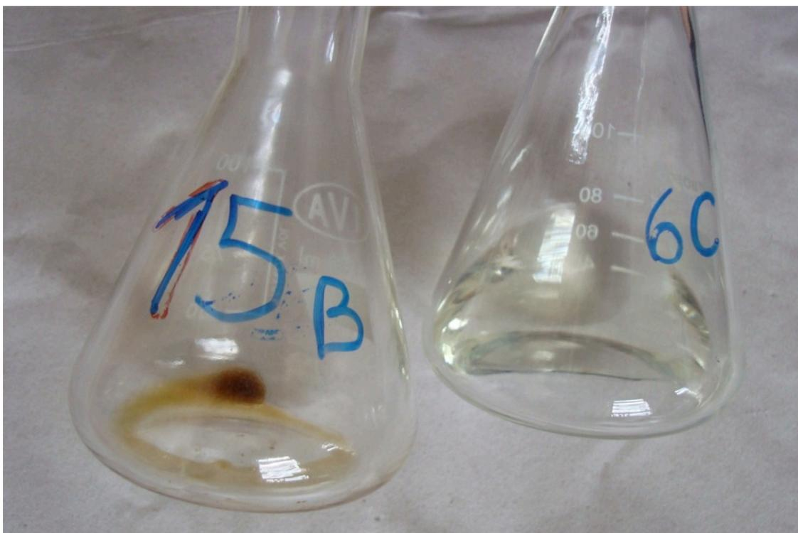
Figura 6. Diferencias entre los hidrocarburos extraídos en el sistema abiótico (izquierda) y el sistema tapado. Nótese la diferencia de color y apariencia entre ambos
