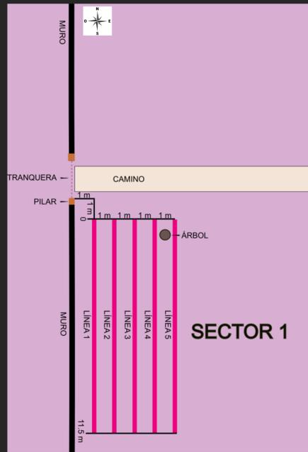
Esquema con la ubicación de las líneas de geoelectrónica indicada. Se utilizó la configuración dipolo-dipolo con aberturas de 50 cm.
