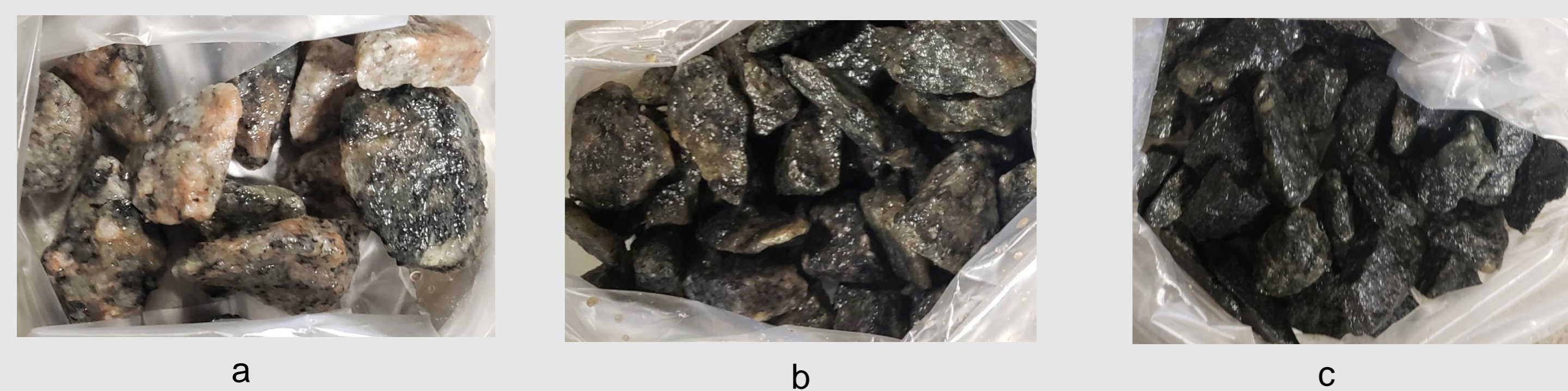
Fig. 2 - Variaciones litológicas identificadas en la fracción de agregados retenidos en el tamiz 1/2": a- Granito rosado, b- Granito gris, c- Facies micácea.
