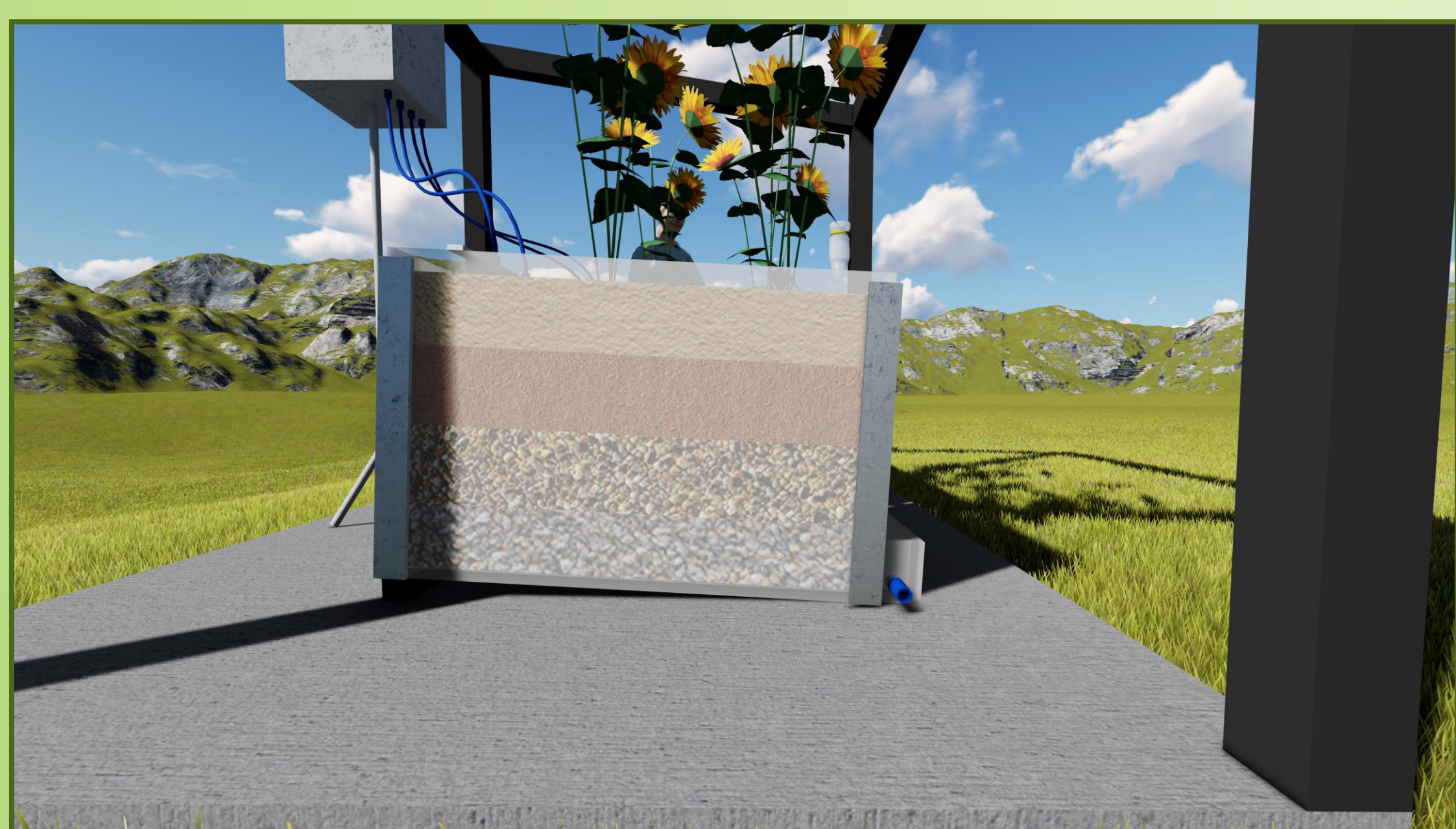
Figura (1): Diseño de BR en policarbonato alveolar.
