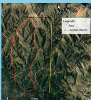
Se realizó la medición directa del Área (A), Perímetro (P) y Longitud máxima de la cuenca con Google Earth.
