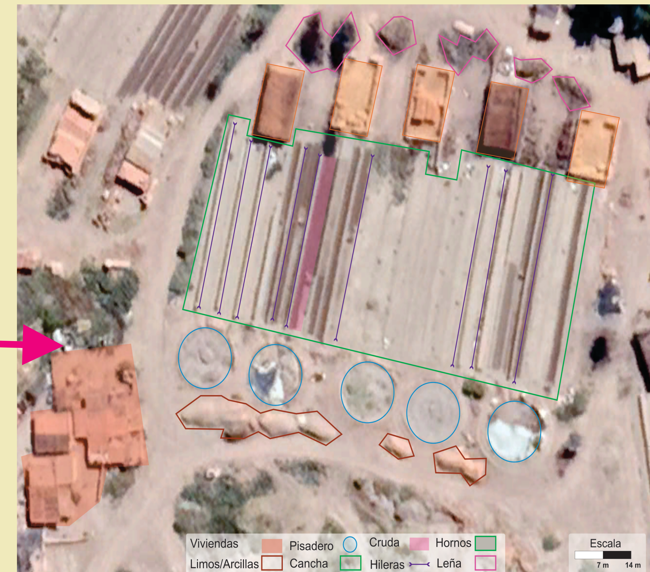
Figura 3 - Caracterización funcional y espacial de un campamento ladrillero.
