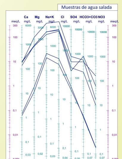
En el relevamiento de pozos se registró que en todos los casos las perforaciones eran someras alcanzando como máximo 3,5 m de profundidad, encontrándose el nivel freático a 0,5 m de la superficie. El pH del agua es poco variable con valores neutros a levemente alcalinos mientras que la CE varió entre 0,47 y 40,1 mS/cm registrándose en sólo 3 de las 23 perforaciones relevadas la presencia de agua dulce.
