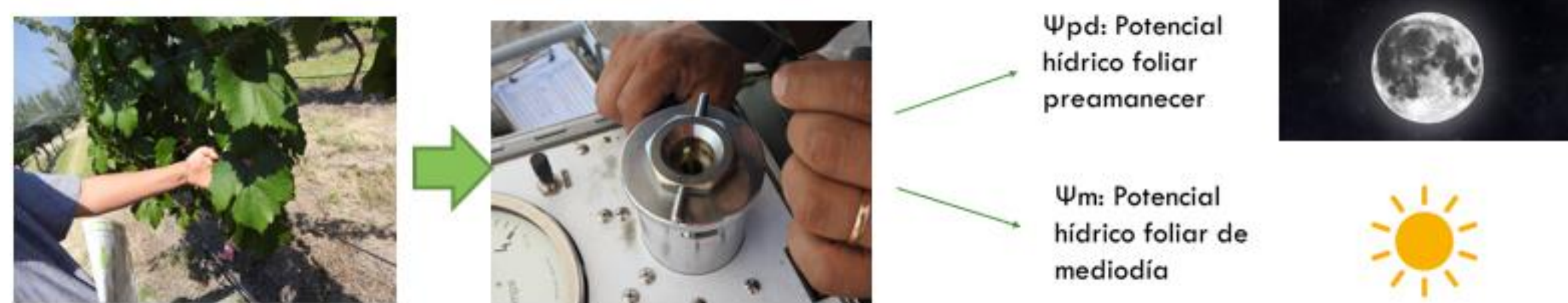
Figura 2. Procedimiento de determinación de potencial hídrico foliar, mediante la visualización de la primera gota de savia en cámara Schölander presurizada con nitrógeno.
