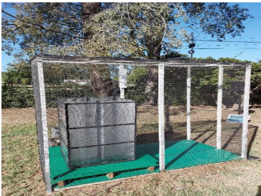
Figura 12. Biorreactor de doble celda, estructura metálica con protección de malla antigranizo y base del biorreactor con pendiente al 6 %.
