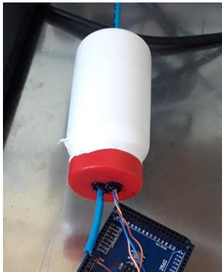
Figura 5. Cámara del sensor de gas
