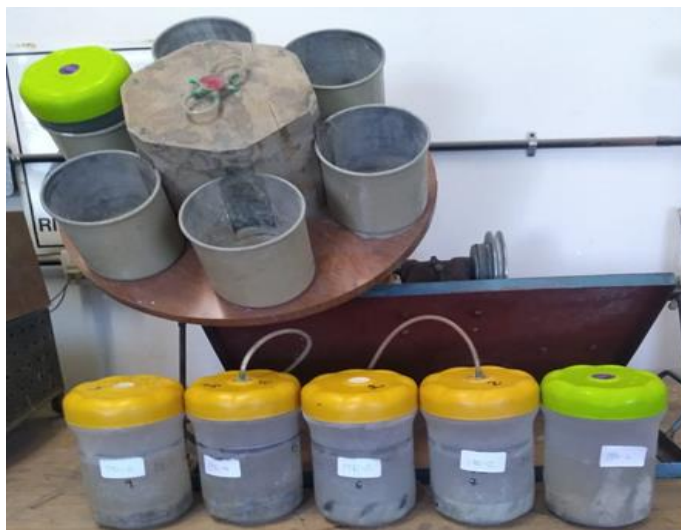
Figura 1. Ensayo de solubilidad de las muestras en estudio llevado a cabo en el extractor rotativo.
