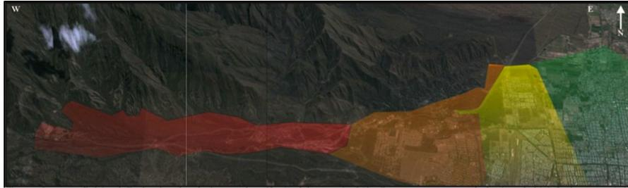
Figura 9. Imagen satelital Google Earth en la cual puede observarse la zonificación de la cuenca Papagayos. Esta cuenca es una cuenca de alto riesgo de debris flood (117 puntos), pero a partir de zonificarla se determinó que el área marcada en color rojo presenta Muy Alto a Alto Riesgo; el área marcada con color naranja presenta Moderado Riesgo; mientras que las marcadas en color Amarillo y Verde presenta Bajo a Muy Bajo Riesgo.
