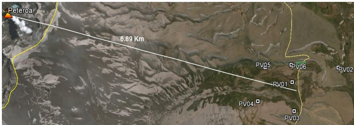
Figura 3. Distribución geométrica de estaciones y su relación con la ubicación del volcán Peteroa. Puede observarse aquí la distancia de 6.89 km entre el volcán y aproximadamente el centro del array.
