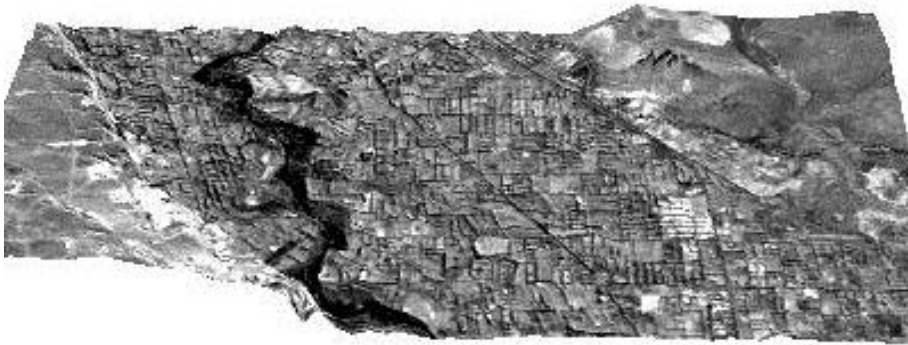
Figura 2: Vista en 3D de la superficie para valores de Albedo del día 16 de julio de 2001, calculado según ecuación (2) e información topográfica del modelo de elevación digital SRTM ( http://glovis.usgs.gov )
