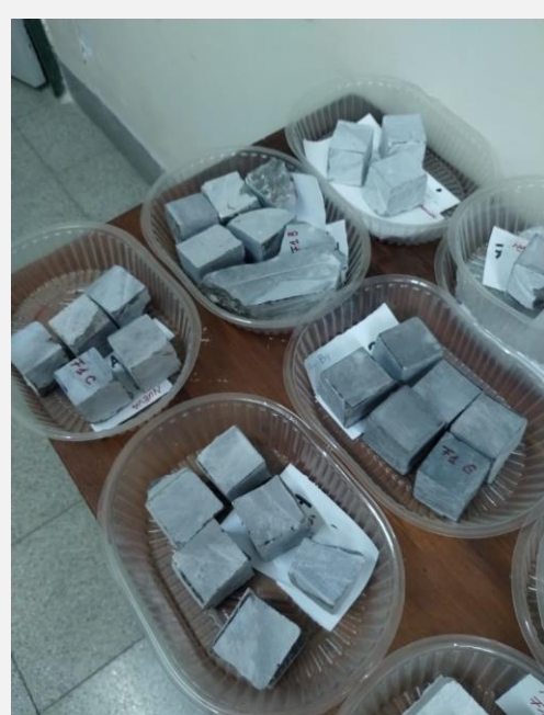
Probetas cúbicas de rocas calcáreas
