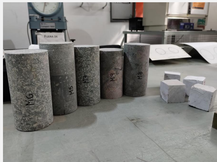
Probetas cilíndricas de rocas piroclásticas
