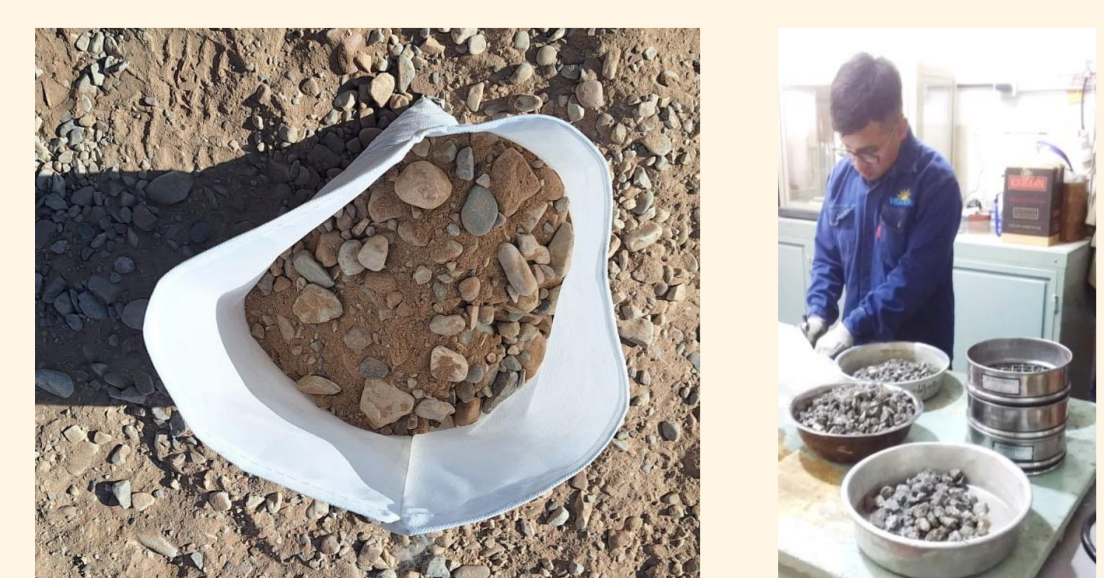
Imagen 3. Detalle de muestra extraída en campo y posterior tamizado en laboratorio
