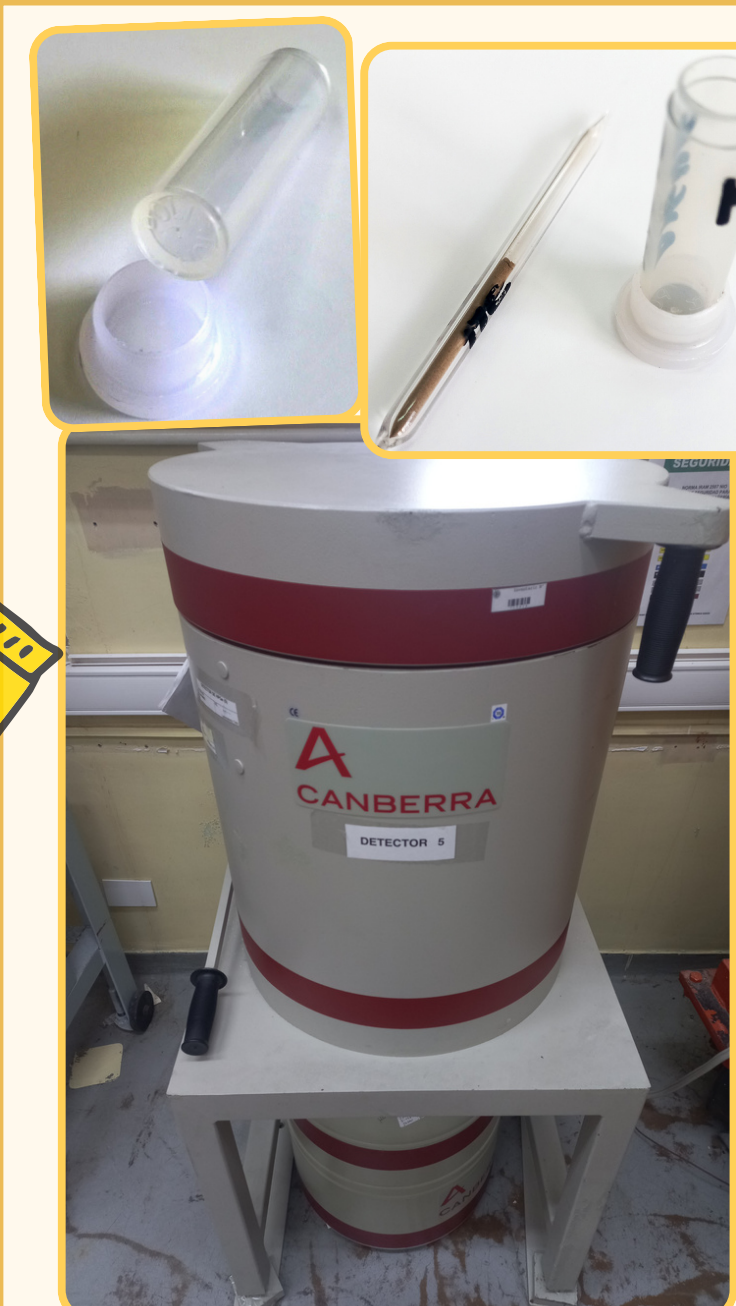
Apertura y medición de muestras irradiadas: el laboratorio TAN cuenta con 5 líneas de medición con detectores de GeHP para espectrometría Gamma. La adquisición y análisis de los espectros se realiza con el programa GammaVision y el cálculo de las concentraciones elementales con software propio desarrollado en el laboratorio.
