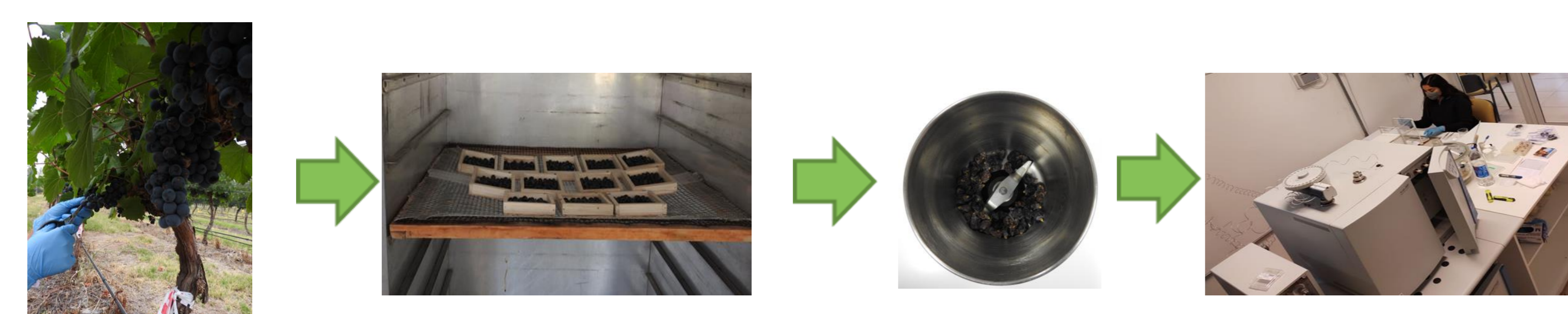
Figura 3. Toma y preparación de muestra para su posterior medición en el espectrómetro de masas de relaciones isotópicas (IRMS).
