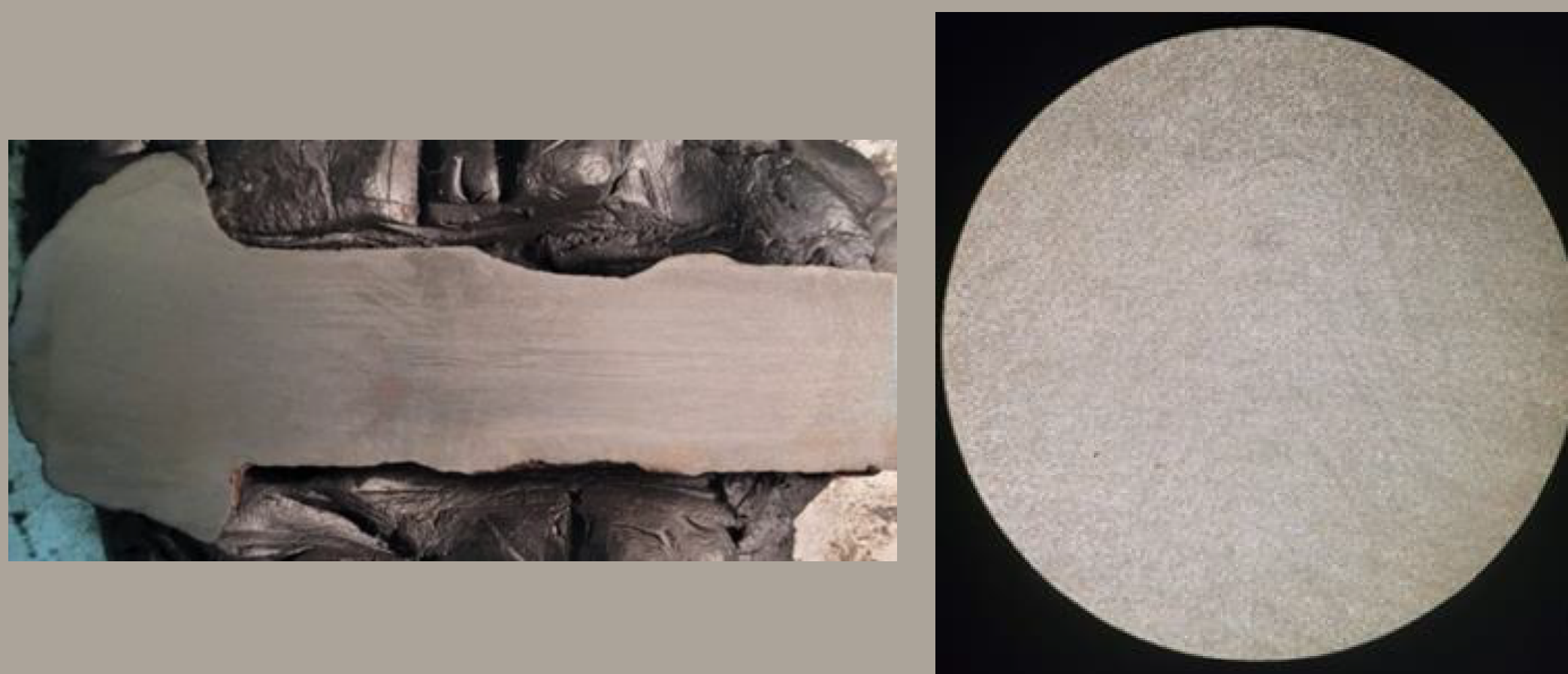
Figura 4. Macrografías perno roscado a. General. b. Zona puntual de cabeza. Aumento: 0.80µm
