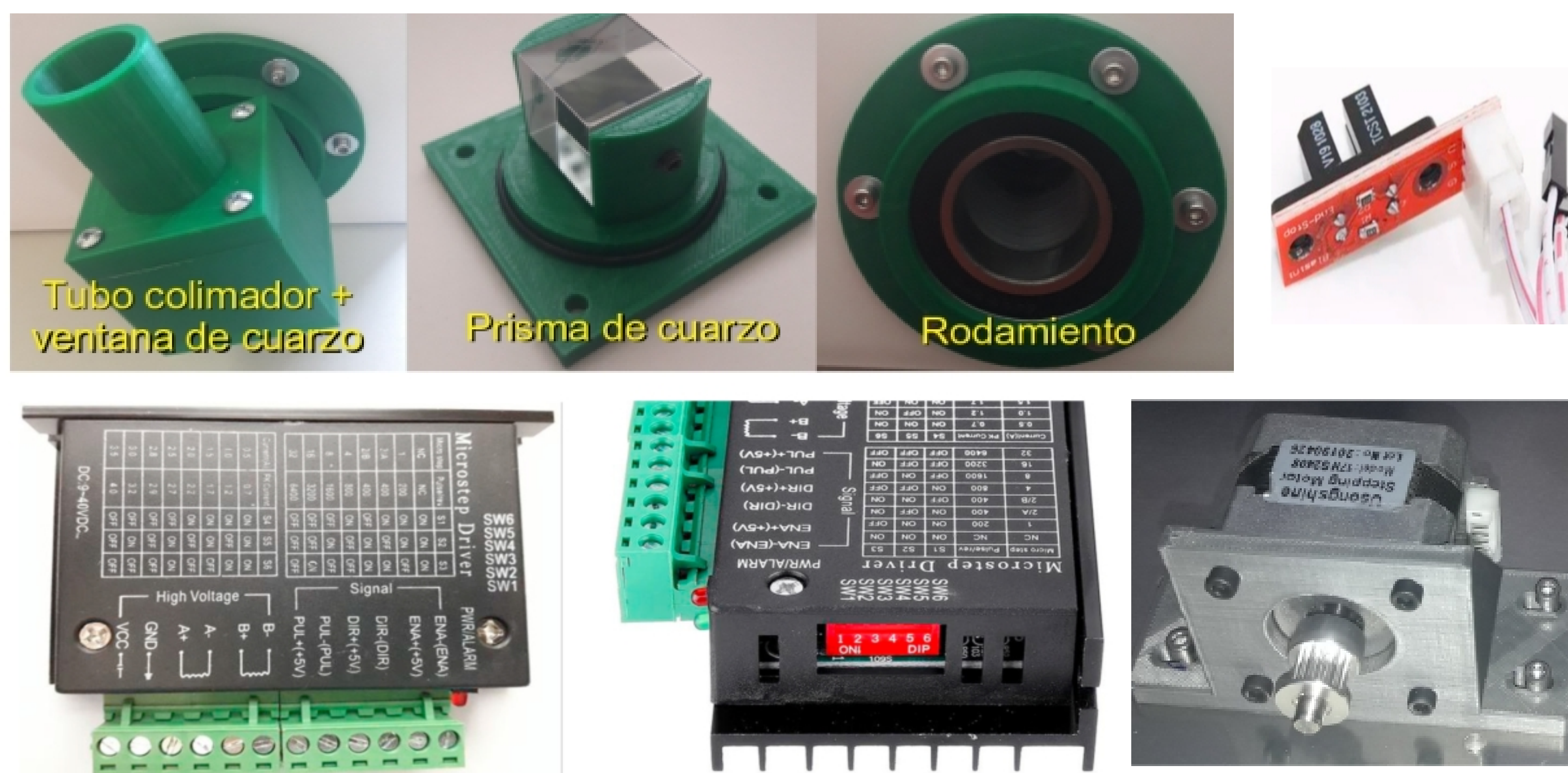
FIGURA 2: Superior) Piezas que conforman el módulo de escaneo, impresas con material PLA (ácido poliláctico) utilizando una impresora 3D (Prusa i3 MK3), y sensor IR. Inferior) Driver/motor paso a paso.
