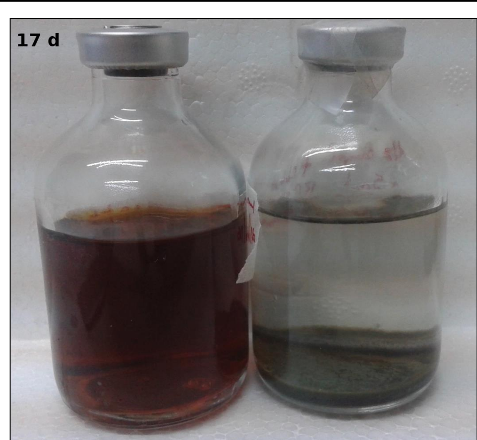
Fig. 1: Viales de biosíntesis de cristales a 17 días. Izquierda: vial control, inoculado con comunidad bacteriana autoclavada. Derecha: vial inoculado con la comunidad activa.
