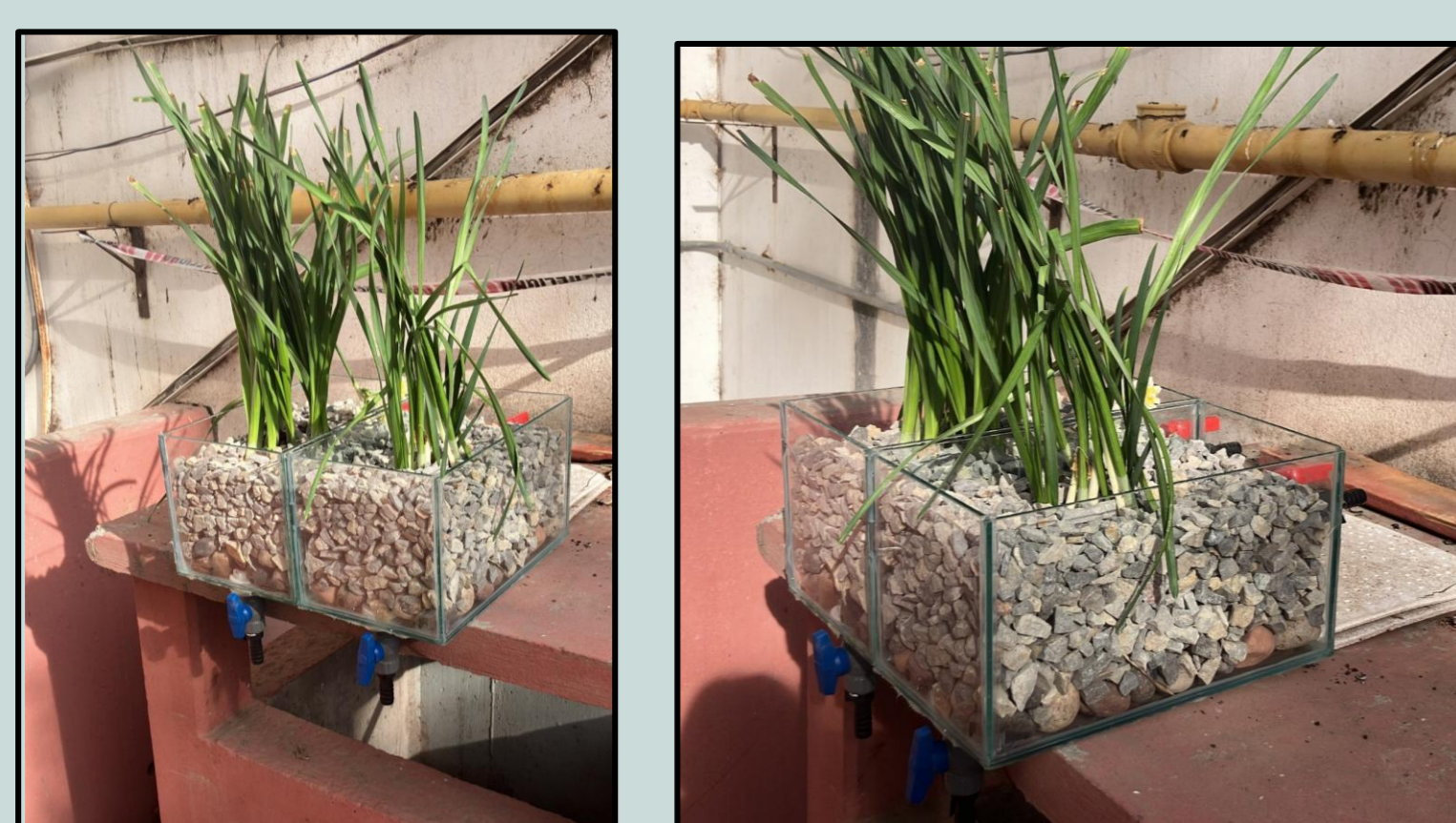
Figura 1. Imágenes del humedal construido.
