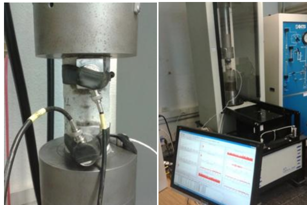
Figura 3: Configuración experimental y equipo de medición de EA.
