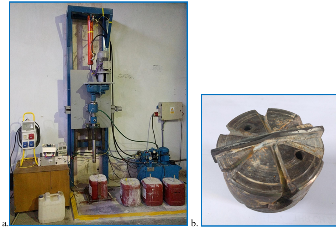
Figura 1. a. Sistema completo de perforación con control de velocidad, centralina hidráulica, y herramienta de perforación. b. Detalle de la broca con cuerpo realizado en SAE 4140, dos fillos de carburo de W y salidas de fluido.
