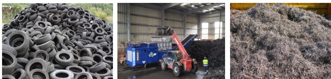
Figura 5: Obtención de fibras de acero recicladas a partir de neumáticos en desuso.
