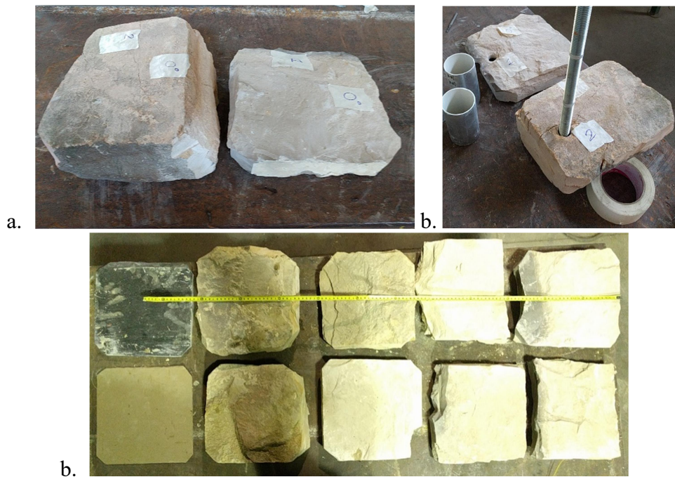
Figura 3. a. Dos tipos diferentes de estratos con variación considerable en el espesor. b. Estratos con guías de onda colocadas. c. Diferentes estratos utilizados para ensamblar las probetas.
