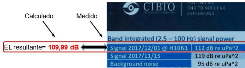
Figura 9. Comparación del nivel de presión calculada y la determinada en la calibración
