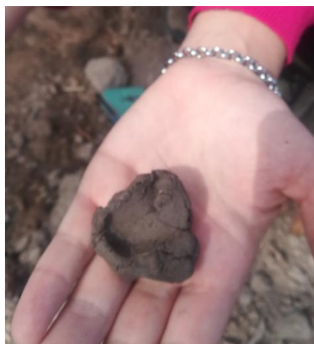
Figura 5 - Suelo mojado. Se observa adhesividad y plasticidad
