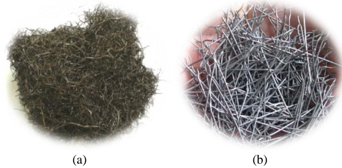
Figura 6: (a) Fibras recicladas y (b) fibras industriales usadas en la campaña experimental.
